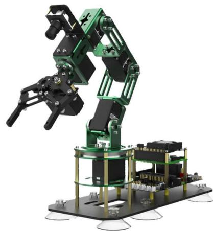
Figure 2 Bras robotique Dofbot
