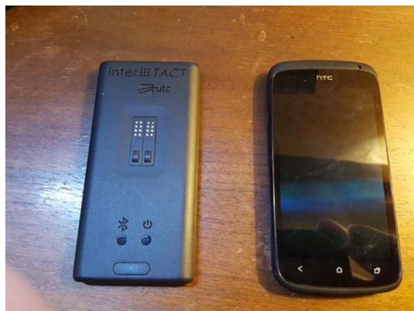
Le Module d'Interaction Tactile intègre 16 picots piezoélectriques. Se connecte au smartphone par Bluetooth. Peut être fixé au dos du smartphone.
