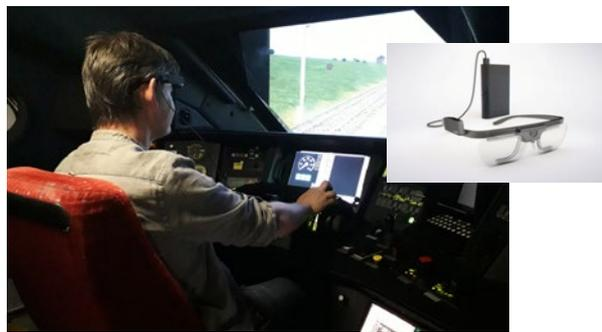
Capture du mouvement des yeux en poste de conduite TGV
